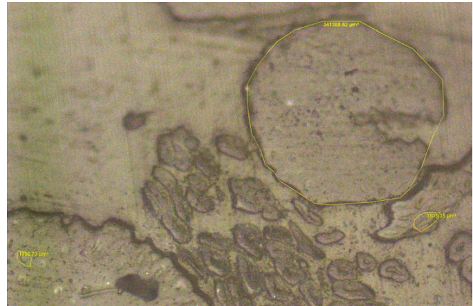
Figura 8.7 Micrografías de las fibras inmersas en la resina.
